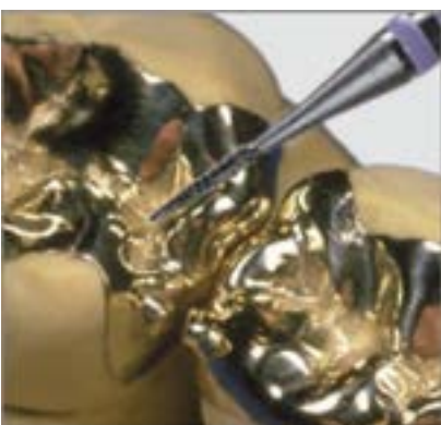
Pour sillons et menues corrections des intrados
