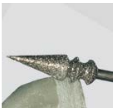
Usinage des bords de porte-empreintes et réalisation de stries de rétention
